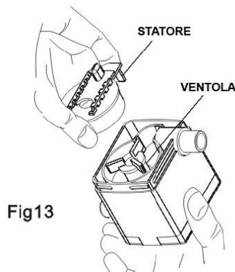
8. Una volta tolto il motore sarà possibile rimuovere la ventola (a 3 pale in metallo) tenuta ferma magneticamente. Per rimuovere la ventola posizionare l'unghia sotto una delle pale e tirare (figura 14).
